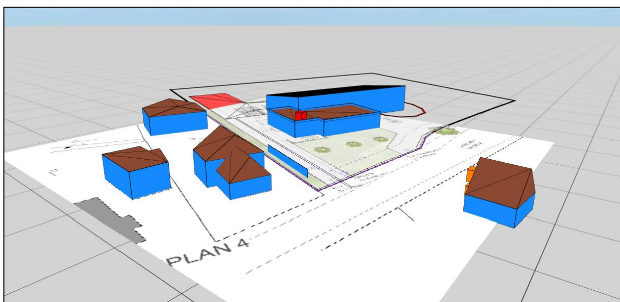
Abbildung 10: 3D-Darstellung der erforderlichen Lärmschutzwände (blau gekennzeichnet).
